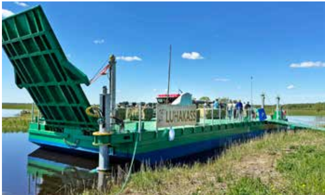
Nüüd Alam-Pedja veeteedel sõitval diiselmootoriga parvel Luhakass on pikkust 23 ja laiust 7,5 meetrit.
